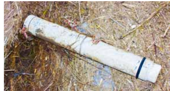
Oben: Der Langenesser C-Pod war nach sieben Jahren im Meer noch intakt. Unten: Auch der C-Pod, den Rainer Schulz am 25.2.19 vor St. Peter fand, gab nach fünf Jahren die aufgezeichneten Schweinswalclicks preis.
